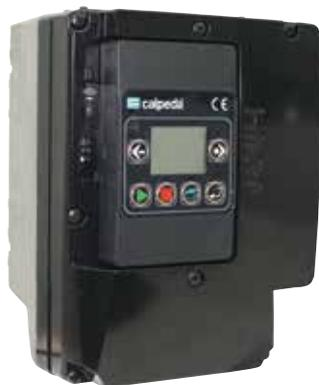
Système à vitesse variable par régulation de fréquence pour pompe de surface ou immergée. Commande le démarrage et l'arrêt d'une ou plusieurs pompes en fonction du mode sélectionné. Paramétrage facile directement sur l'IMAT grâce à l'écran LCD et au menu déroulant. Protège la pompe contre : Marche à sec - Surintensité - Sous ou surtension. Limites d'utilisation : + 50°C - Indice de Protection **IP55**. L'IMAT s'installe sur un support mural déporté.
