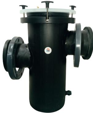
Préfiltres en polyéthylène haute densité (PEHD) avec couvercle transparent à ouverture rapide et panier de récupération en INOX 316 (maille Ø5 mm).
