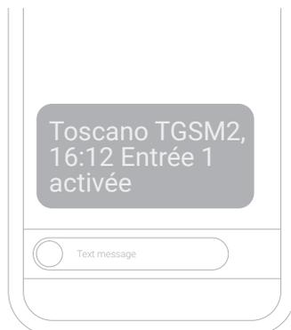
Lorsque l'entrée 1 ou l'entrée 2 passe de l'état inactif à l'état actif, le module TGSM2 envoie un SMS l'indiquant en précisant l'heure de l'événement.
