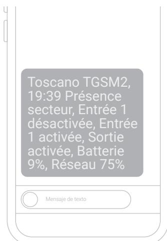
Lorsque la batterie du module TGSM2 tombe en dessous de 10%, le module envoie alors un SMS d'état en précisant l'heure de l'événement.
