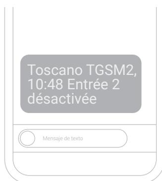
Lorsque l'entrée 1 ou l'entrée 2 passe de l'état actif à l'état inactif, le module TGSM2 envoie un SMS l'indiquant en précisant l'heure de l'événement.
