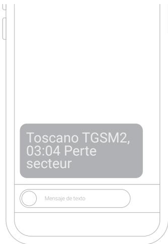
Lorsqu'une coupure de tension se produit sur le module TGSM2, celui-ci envoie un SMS l'indiquant en précisant l'heure de l'événement.
