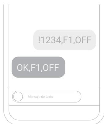
L'envoi de ce message désactivera la fonction de compteur d'impulsions à l'entrée indiquée, F1 pour l'entrée 1 et F2 pour l'entrée 2. L'entrée sélectionnée reviendra à son mode de fonctionnement normal.
