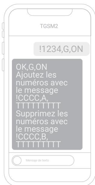
Active le mode d'ouverture de la porte. En option, vous pouvez inclure la durée en secondes pendant lequel la sortie doit être active. Si cette durée n'est pas ajoutée, la sortie restera active pendant 10 secondes.
