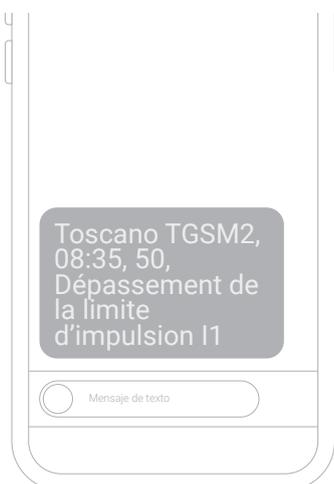
Si l'option du compteur d'impulsions est activée (voir page 19) et que la limite d'impulsions établie est dépassée, le module TGSM2 envoie un SMS l'indiquant en précisant l'heure de l'événement.
