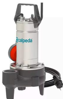
Pompe de relevage à roue vortex. Pour eau chargée. Corps de pompe en fonte.
