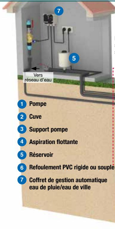
Schéma de principe
