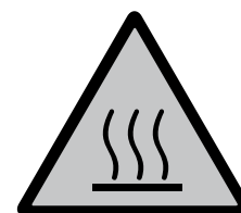
Etichetta di identificazione delle superfici a rischio di surriscaldamento
