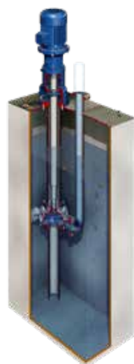
Standard Installation mit einem Saugrohr
