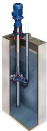
Standard Installation mit einem Saugrohr
