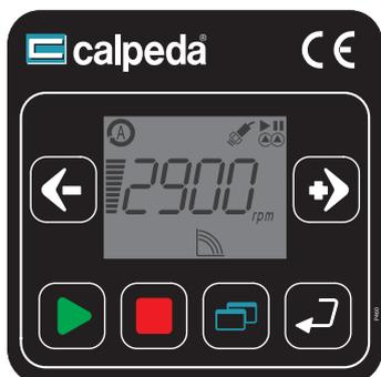
EASYMAT ist ausgestattet mit einem Bedienfeld sowie einem Display, das die Einstellung und Überwachung einer Vielzahl von Systemparametern ermöglicht.
