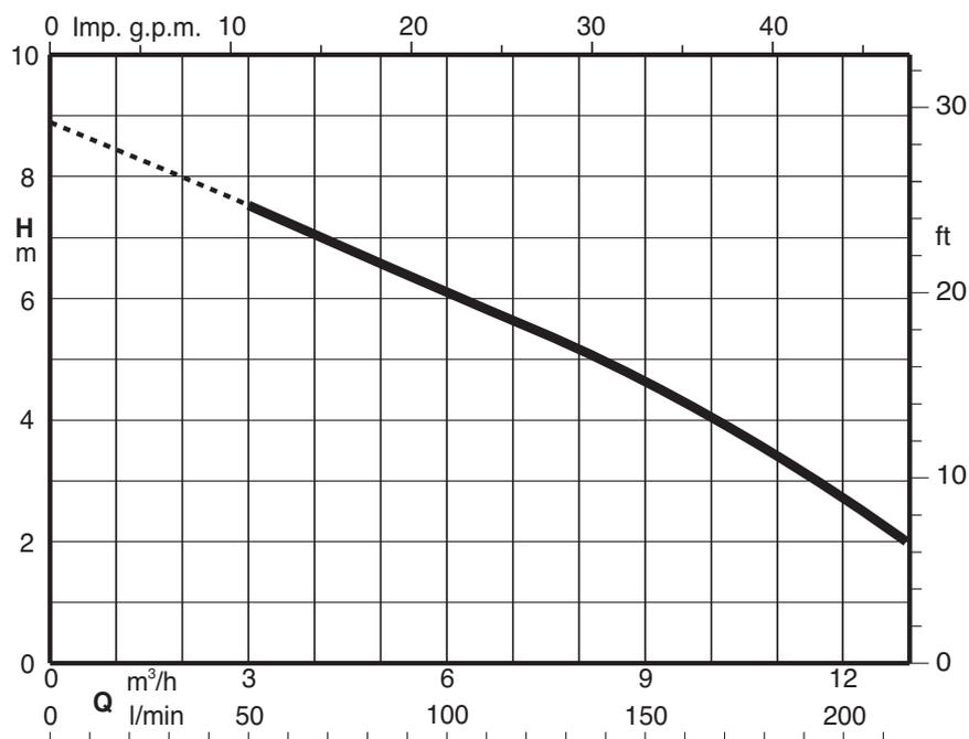
Bomba submersível para drenagem
