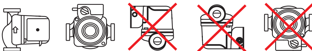
Fig2 posizione di installazione dell'elettropompa
