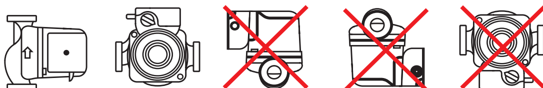
Fig2 installatiepositie van elektrische pomp
