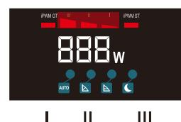
En mode vitesse fixe, trois vitesses de moteur de pompe peuvent être préréglées en fonction du système de pompe spécifique, SPD1, SPD2 et SPD3, qui sont caractérisées par le fonctionnement de la pompe à une courbe de vitesse constante prédéterminée.
