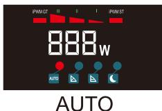
Im adaptiven Modus wird die optimale proportionale Druckkurve (schraffierter Teil) auf der Grundlage der über einen bestimmten Zeitraum gesammelten Betriebsdaten des Systems ausgewählt, die zur Analyse des aktuellen Bedarfs des Systems verwendet werden.
