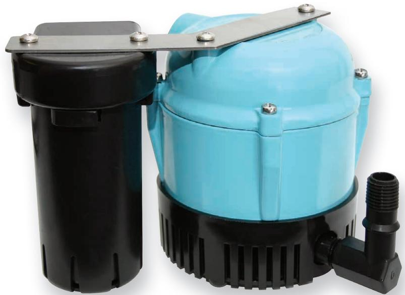
Automatische Kondensatpumpe zur Montage in Tropfschalen und eingebauten Behältern. Der angebaute Magnetschalter startet die Pumpe bei ca. 63 mm Wasserstand und schaltet diese bei ca. 38 mm wieder aus. Epoxydharzbeschichtetes Aluminiumgehäuse. Ölgefüllter Motor für Dauerbetrieb auch bei ausgetauchter Pumpe. Mit 1.8 m Anschlusskabel und Schukostecker.
