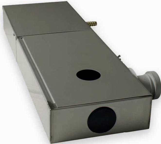
Die DCP-30A wurde entwickelt, um Kondensat von Kühlregalen und Theken zu entfernen. Hergestellt aus rostfreiem Stahl, gewährleistet die Pumpe eine konstante Nutzung und eine längere Lebensdauer. Der Tank hat eine Kapazität von 5 l, der Kondensateinlass sitzt im oberen Teil. Das ultraflache Design, passt unter die meisten Kühlvitrienen und Theken.
