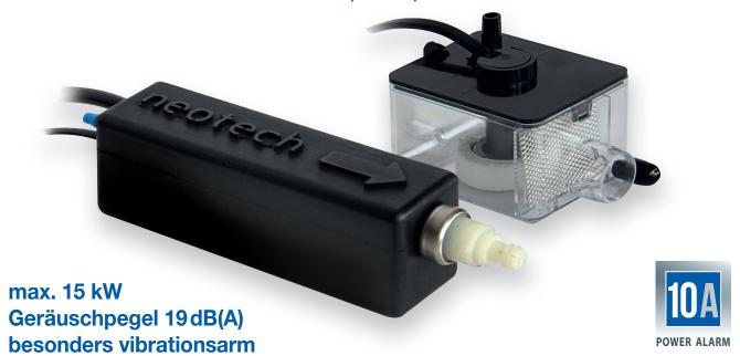
Die Pumpe und der Tank sammeln und entleeren das Kondensat. Die kleinen Abmessungen und die schnelle Verkabelung ermöglichen eine einfache und flexible Installation. Der Sammeltank kann innerhalb bzw. rechts oder links der Klimaanlage installiert werden. Das Alarmsignal hat 2 Kontakte und ist als Öffner oder Schließer verwendbar.
